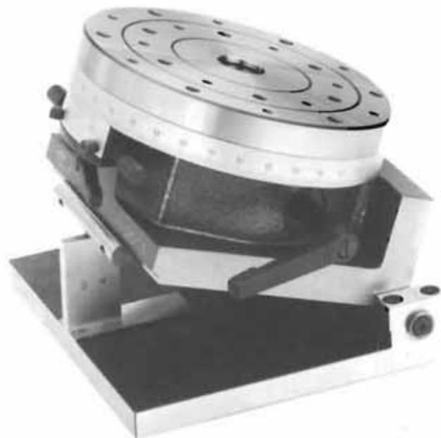
**H 200 S Plateau diviseur circulaire sinus**, Exécution comme H 200, mais avec plateau sinus pivotant dans un plan de 0-60°. Réglage à l'aide de cales étalons déterminées avec la table trigonométrique livrée avec l'appareil.
