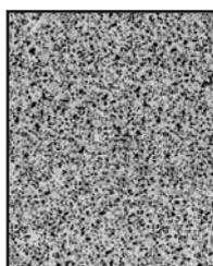
L'EDM-3 de POCO est un graphite isotropique à grain ultra-fin, combinant une grande solidité à un taux d'usure remarquablement bas et à une finition très bonne de surface, permettant un usinage facile pour des épaisseurs de 0,1 mm et moins.
