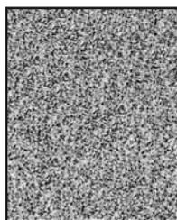
L'EDM-AF5 de POCO est le seul matériau graphite pour électrodes aujourd'hui disponible dont les particules ont une dimension moyenne de moins d'un micron. Cette structure de particules confère à l'EDM-AF5 une solidité et une finition de surface sans pareille, (1.18µmRa), assure un excellent taux d'enlèvement de métal et une résistance supérieure à l'usure.
